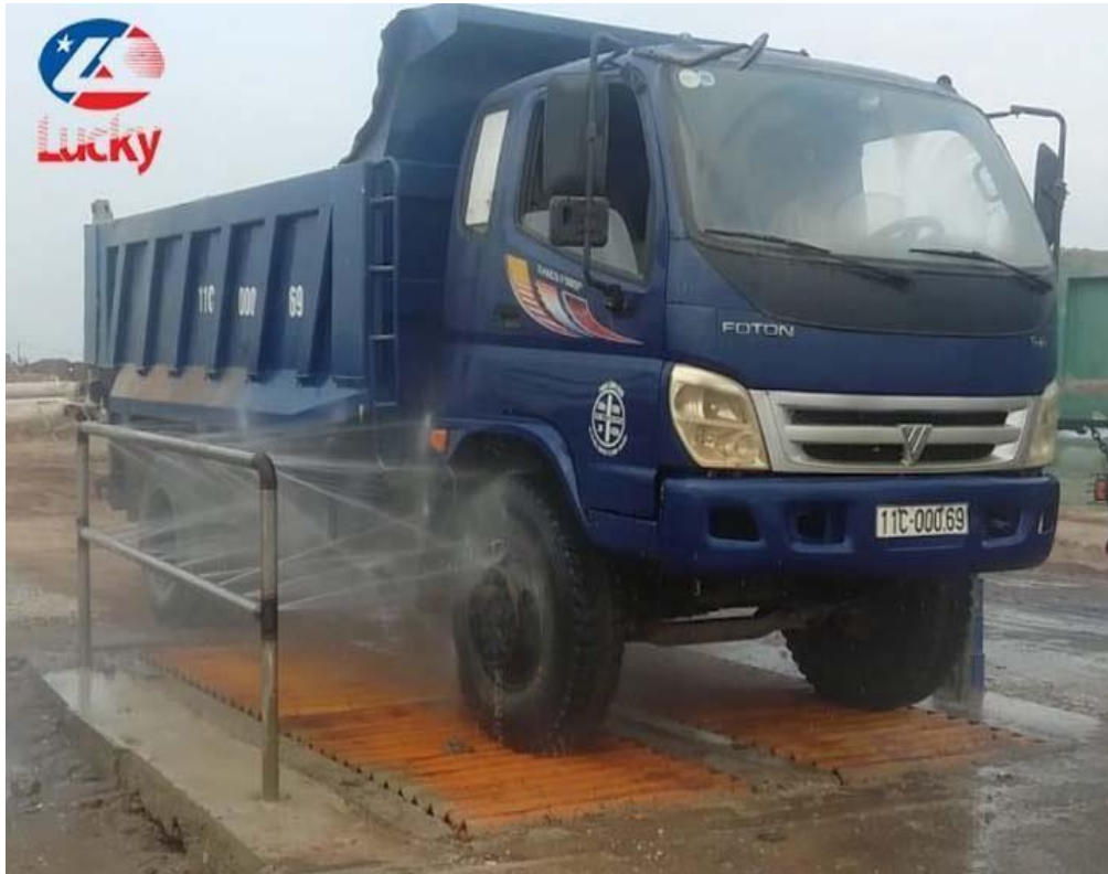
Hình 1: Hình ảnh hệ thống rửa xe công trường
